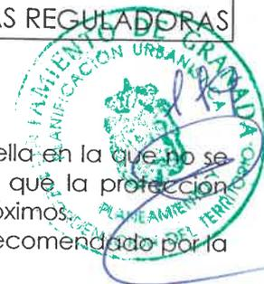
En todos los casos de paralelismo la longitud a proteger será toda aquella en la que no se cumplan las distancias mínimas y la instalación se realizará de forma que la protección descansa perpendicularmente a la línea de unión de los dos servicios próximos. Los tipos y formas de las protecciones se atenderán a los establecidos o recomendados por la Norma Técnica específica de la compañía suministradora.
